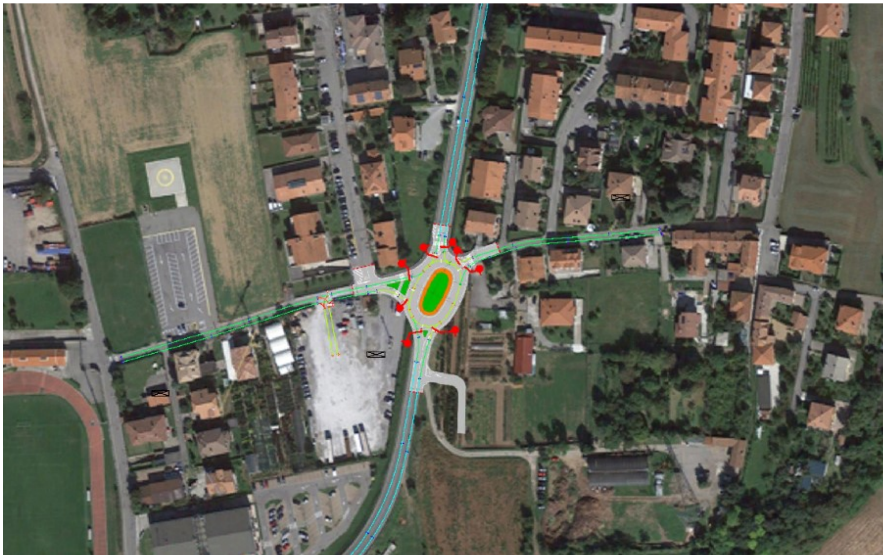
Figura 57 – Schema di rete utilizzato per la microsimulazione – Scenario di intervento 2
