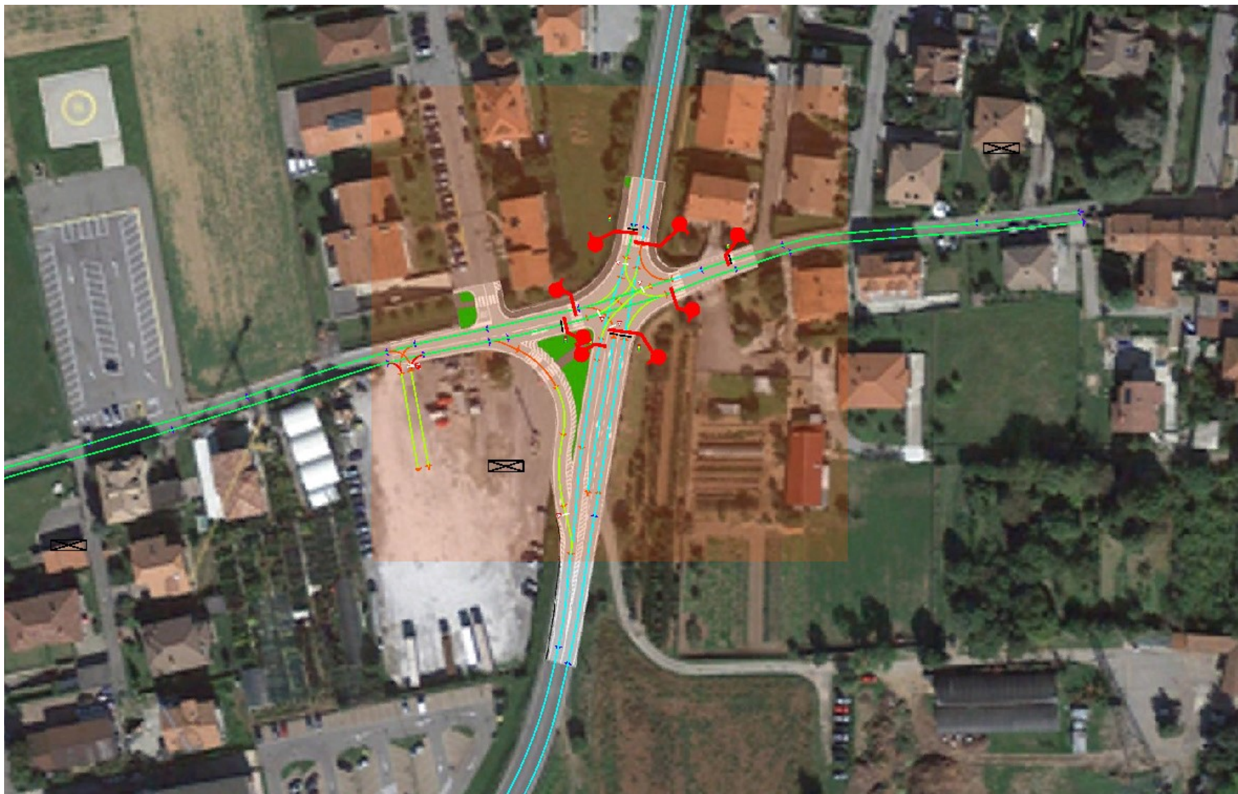
Figura 51 – Schema di rete utilizzato per la microsimulazione – Scenario di intervento 1
