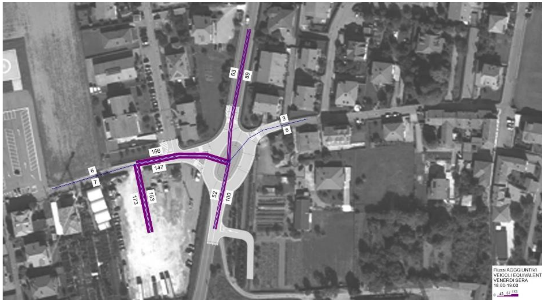
Figura 42 – Scenario di intervento 2 – Flussi aggiuntivi sulla rete – ora di punta venerdì sera (18:00-19:00) – veicoli equivalenti
