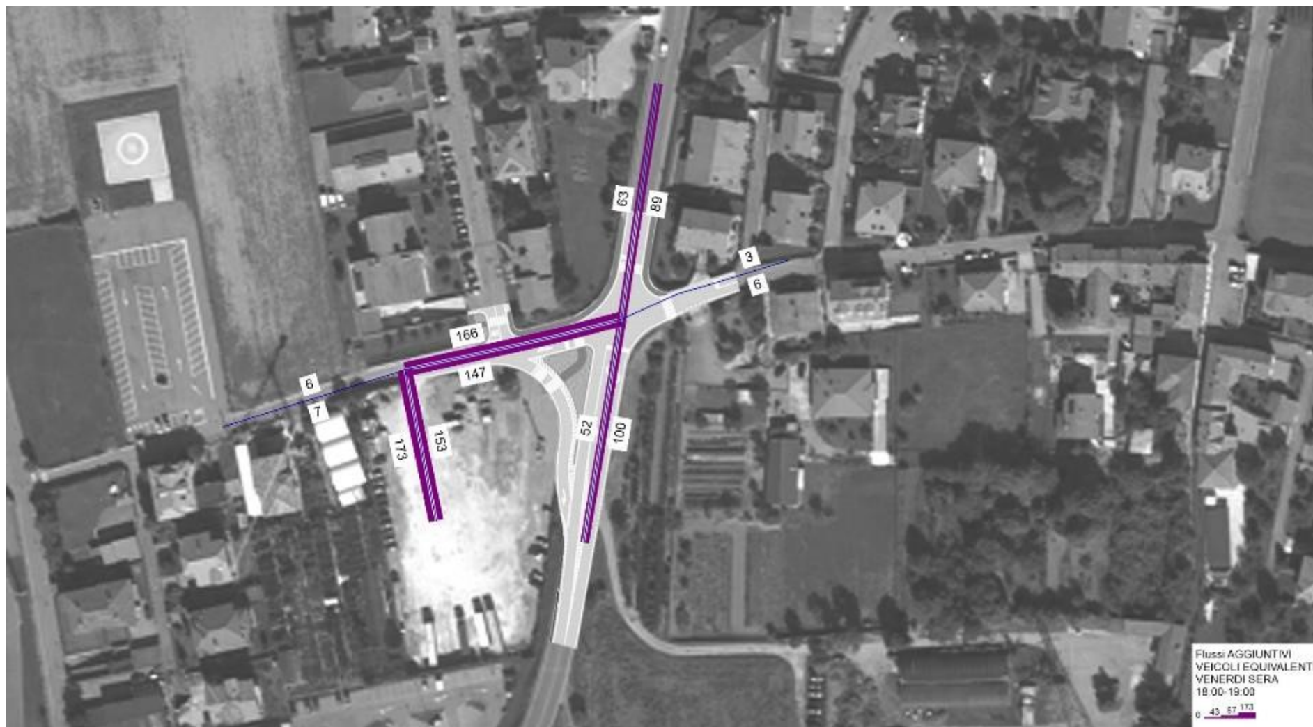
Figura 41 – Scenario di intervento 1 – Flussi aggiuntivi sulla rete – ora di punta venerdì sera (18:00-19:00) – veicoli equivalenti
