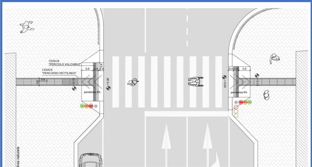
La presenza di palazzi e recinzioni costituisce generalmente una guida naturale per le persone non vedenti; in presenza di strade secondarie o passi carrai con larghezze superiori a 3 metri è tuttavia necessario prevedere l'installazione di pavimentazioni di guida podotattile (eventualmente integrate da adeguate rampe di raccordo tra le diverse quote del marciapiede rispetto alla carreggiata).
